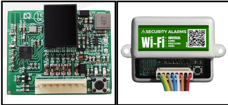
Equipamento que torna um painel de alarme, cerca elétrica ou automatizador de portão conectado a rede Wi-Fi, enviando notificações ao aplicativo celular do usuário.
